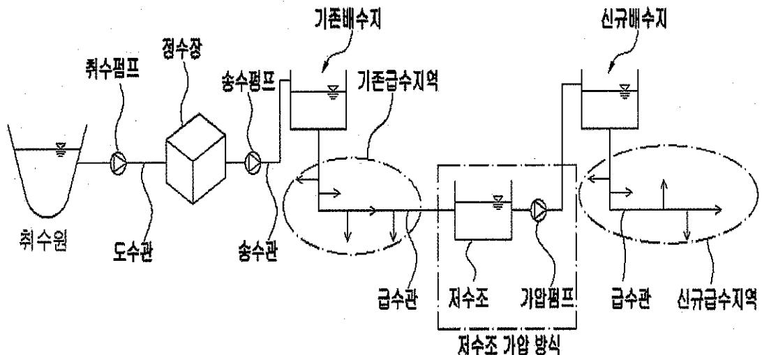
[그림 1] 저수조 가압 방식 시스템 계통도
