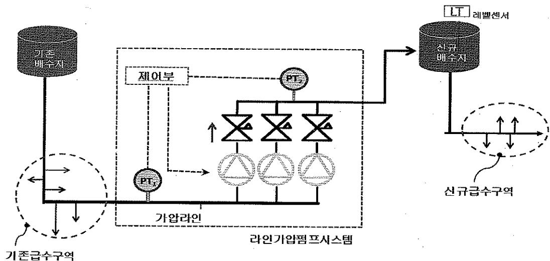
[그림 2] 배수지 전용 라인가압펌프 시스템 계통도
