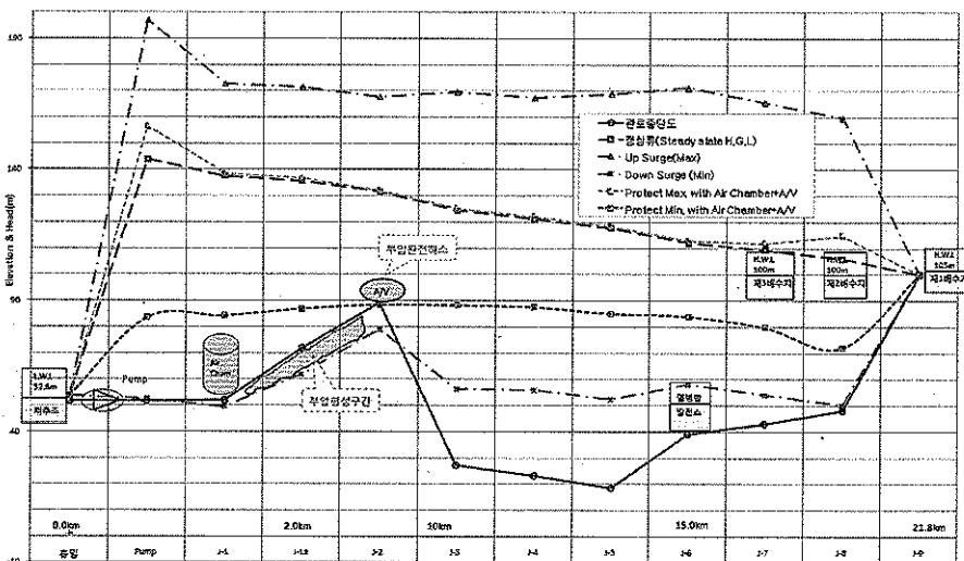
[그림 7] 저수조 가압방식의 펌프급정지 (최고14.5 kg/cm<sup>2</sup>.G, 상향관로 전구간 부압발생)
