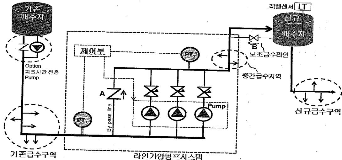
[그림 4] 개선된 라인가압펌프 시스템 계통도
